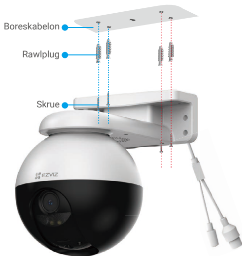
Fig. 1 Montering i loft
